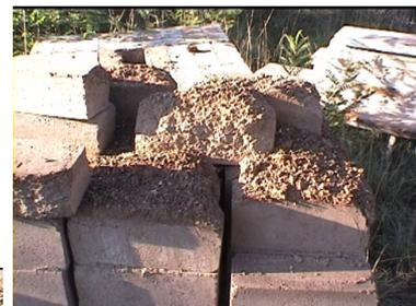
Les briques se désintègrent en l'espace d'un hiver. Ces dégâts ne peuvent être imputés à la pluie du fait de la stabilisation des briques.
