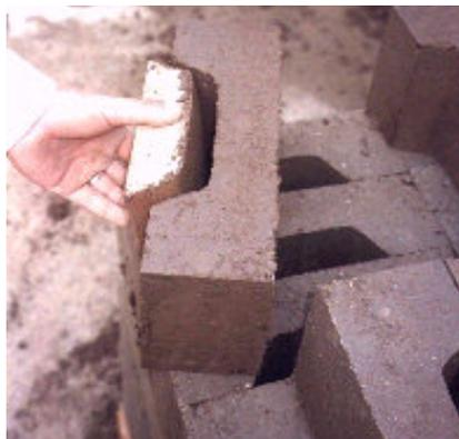
Le rapport du volume de terre foisonnée sur le volume de terre comprimée est d'environ 1,7. Pour garder un taux de compression constant, la terre doit être répartie avant compression dans le moule comme indiqué sur le croquis.
