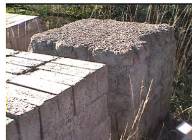
Sur les briques stockées en extérieur sans protection, les dégâts causés par le gel sont très importants.
