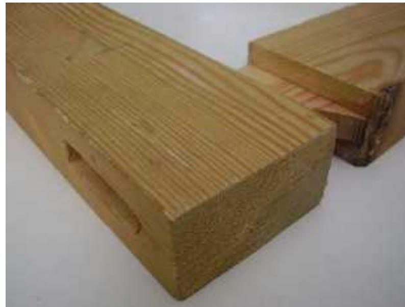
Assemblage par tenon mortaise avec renfort d'épaulement.
