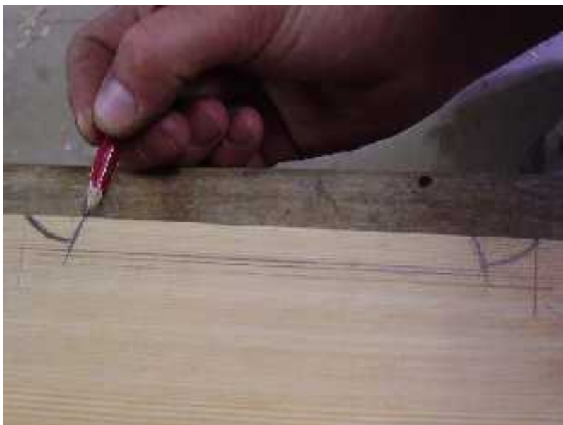
Tracé d'une moulure manuelle
