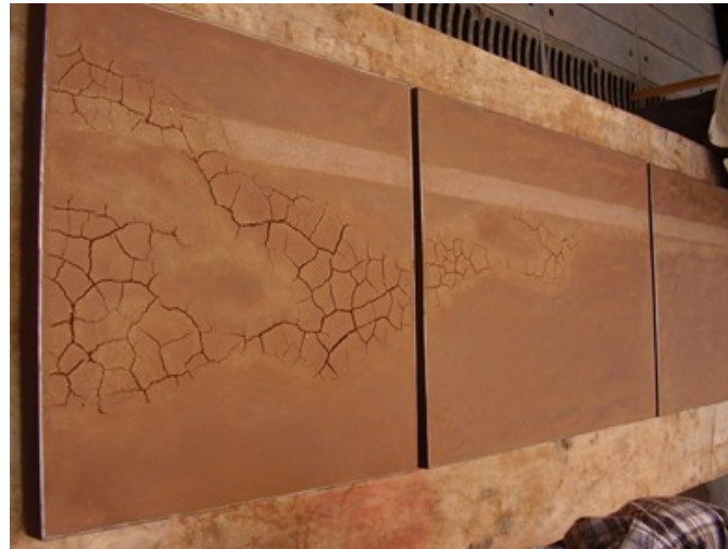
Fissure de surface localisé réalisé volontairement par différence d'épaisseur de l'enduit
